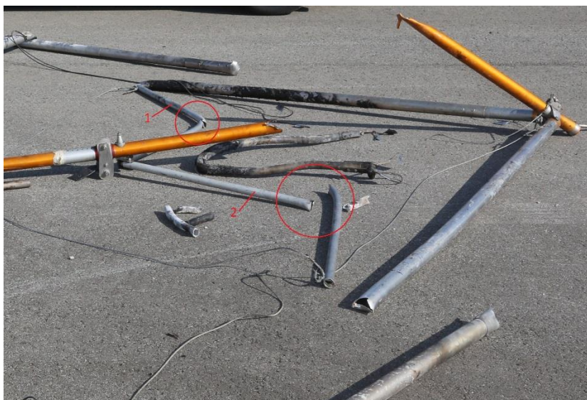
Joonis 2. Purunenud trapetsi torud
