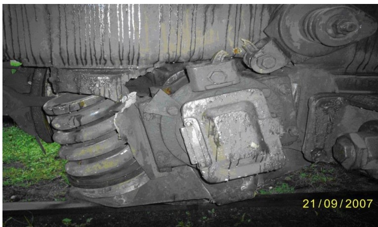
Mootorvaguni 3108 alusvankri nähtavad vigastused
